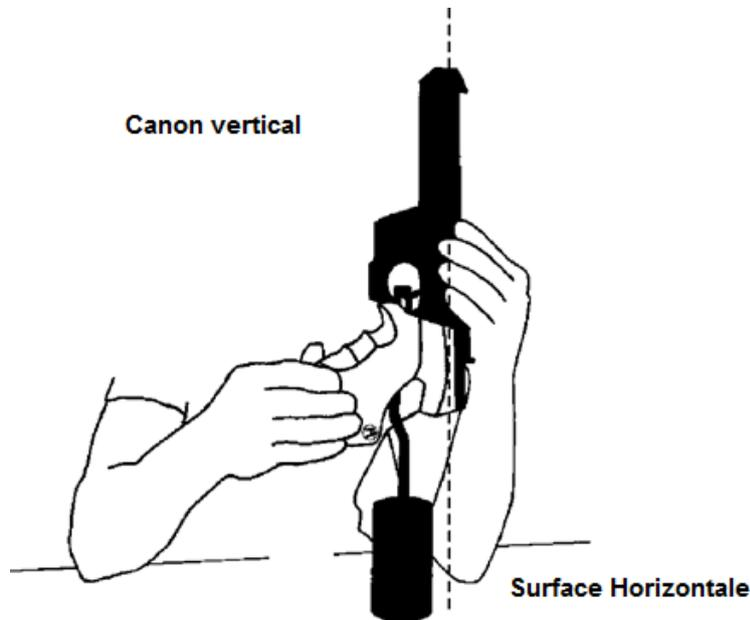
Le poids de détente doit être vérifié en plaçant le peson près du milieu de la détente (voir illustrations) et en maintenant le canon vertical. Le peson doit être placé sur une surface horizontale puis soulevé et visiblement décollé de la surface. Le test doit être effectué par un arbitre du Contrôle des Équipements.
